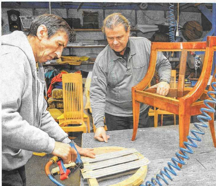
Zum Bespannen eines Sitzrahmens für einen Biedermeier-Stuhl verwendet Mitarbeiter Otto Grebur einen Drucklufttacker. Sein Chef, Raumausstatter Klaus Gerling, schaut ihm dabei auf die Finger.
